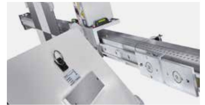
Kalibriertafeln einfach mit Magnethaltern am Präzisionschlitzen anstecken
