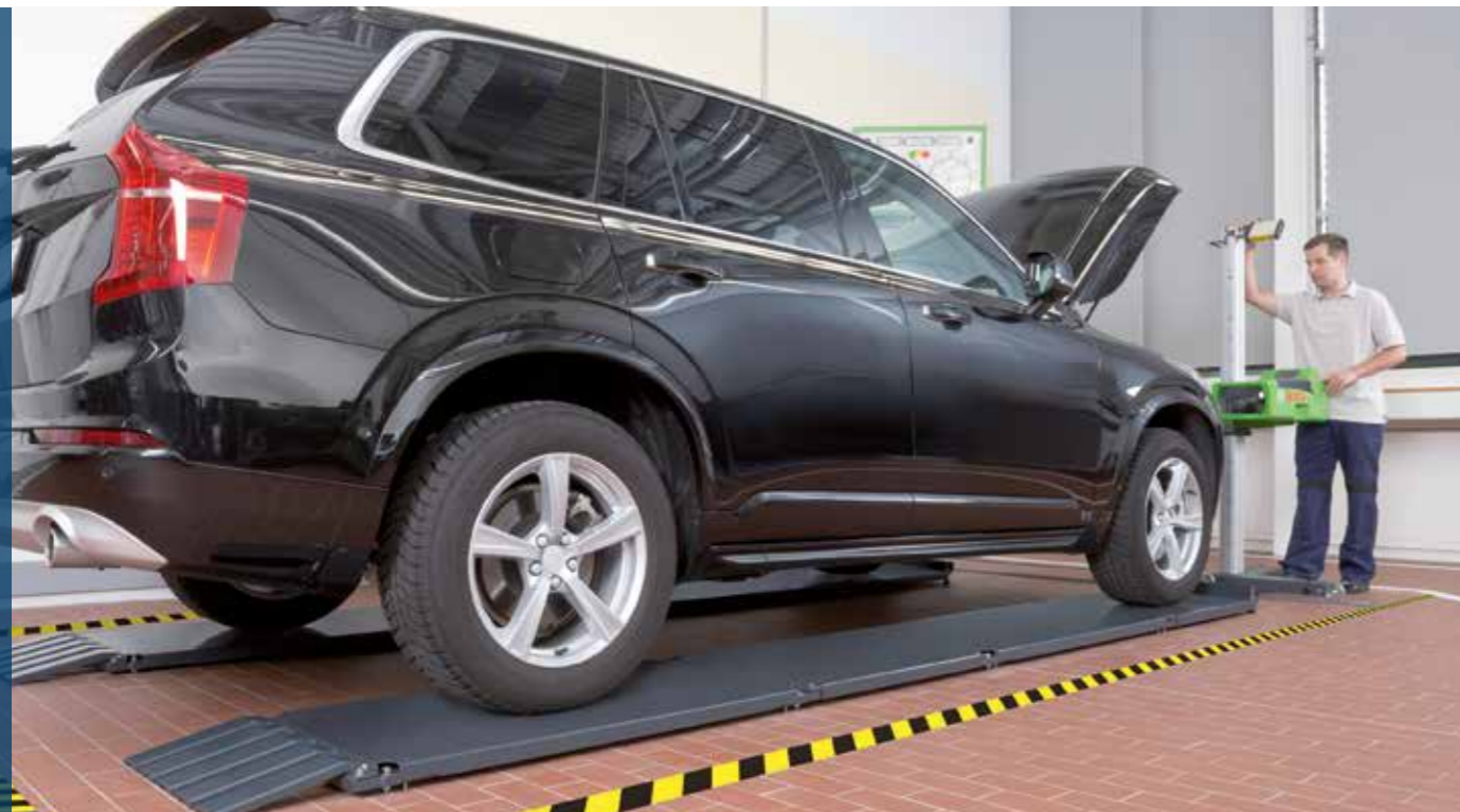
Neu! Bosch-Prüfsystem gemäß § 29 StVZO HU-Scheinwerfer-Prüfrichtlinie: Nivellierbare Fahrzeugprüffläche Bosch LTB 100 mit schienengeführtem Scheinwerfer-Einstellgerät Bosch HTD 815.
