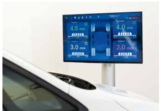
Vorhandener Smart TV mit Messwertanzeige zum Einsatz in Durchfahrtbereichen
